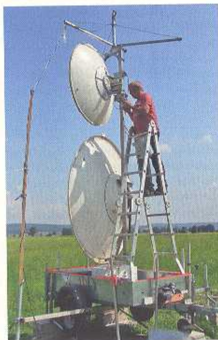
Mit dieser Radarstation werden die Bienen geortet. Fotos und Grafiken: Randolph Menzel
